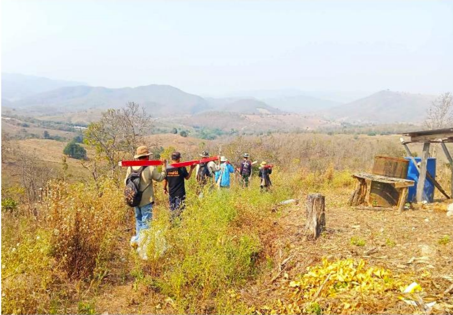
การสำรวจแนวเขตการใช้ประโยชน์ที่ดินรายแปลงที่ตำบลท่าผา อ.แม่แจ่ม โดยการปักหมุดในแปลงที่ดินแล้วใช้เครื่องมือ GPS จับพิกัด
