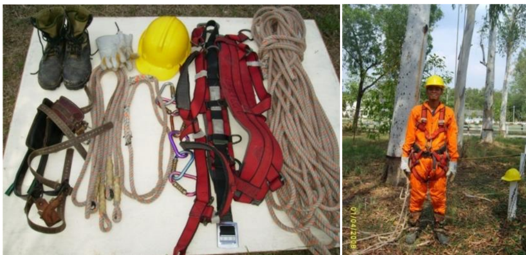
ภาพที่ 3 อุปกรณ์การปีนต้นไม้ (ก) และการแต่งกายของผู้ปีนต้นไม้ (ข)
