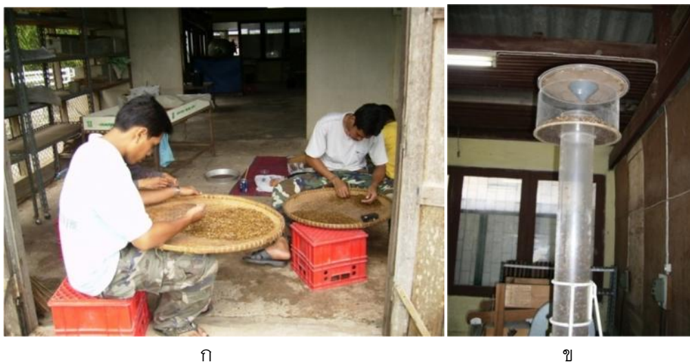
ภาพที่ 10 การคัดแยกเมล็ดเสีย รก เศษของผลหรือฝักที่ปะปนอยู่ออกโดยใช้แรงงานคน (ก) หรือเครื่องมือ (ข)
