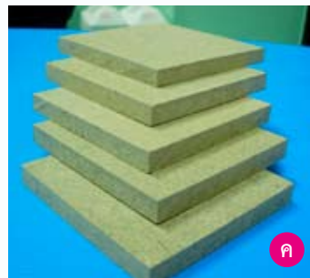
ภาพที่ 11.4 แผ่นไม้ประกอบจากเศษไม้ปลายไม้ (ก) แผ่นเอ็มดีเอฟ (ข) แผ่นขึ้นไม้อัด (ค) แผ่นใยไม้อัดซีเมนต์
