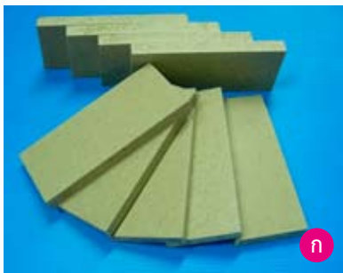
ภาพที่ 11.4 แผ่นไม้ประกอบจากเศษไม้ปลายไม้ (ก) แผ่นเอ็มดีเอฟ (ข) แผ่นขึ้นไม้อัด (ค) แผ่นใยไม้อัดซีเมนต์
