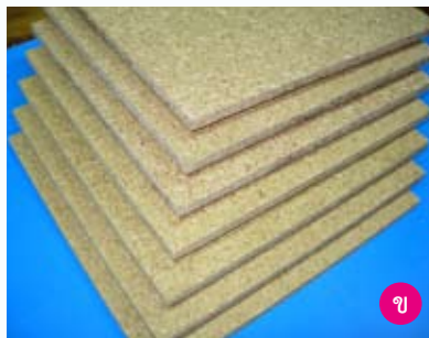
ภาพที่ 11.4 แผ่นไม้ประกอบจากเศษไม้ปลายไม้ (ก) แผ่นเอ็มดีเอฟ (ข) แผ่นขึ้นไม้อัด (ค) แผ่นใยไม้อัดซีเมนต์
