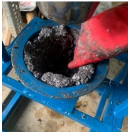
ภาพที่ 4 นำส่วนผสมที่นวดเข้ากันแล้วใส่ใน เครื่องอัดกระถางของมหาวิทยาลัยเทคโนโลยี ราชมงคลพระนคร (ศูนย์พระนครเหนือ) เพื่อขึ้นรูปกระถาง
