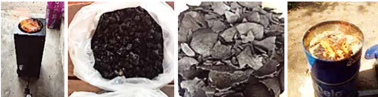
เตรียมตัวอย่างถ่านชาร์จากวัสดุการเกษตร ๔ ชนิด ด้วยเตาเผา ๓ รูปแบบ
