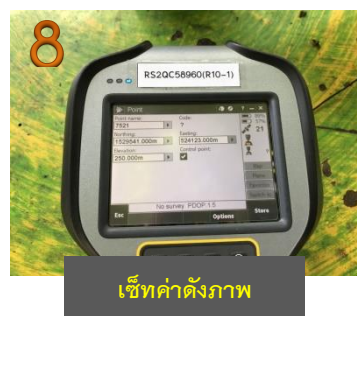
ใส่ชื่อ point ค่า E N elevation จาก หมุดทหาร ตึก control point
