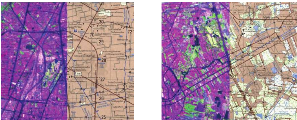
ภาพที่ 8 ความคลาดเคลื่อนทางตำแหน่งราบของภาพถ่ายดาวเทียม Landsat 8 Path 129 Row 50 เปรียบเทียบกับแผนที่ภูมิประเทศ มาตราส่วน 1: 50,000 ลำดับชุด L7018 ของกรมแผนที่ทหาร
