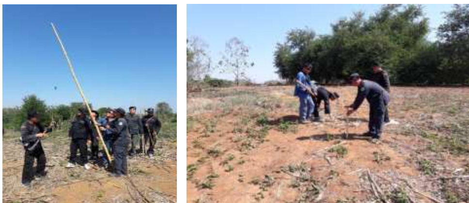
ภาพที่ 7 จำลองวิธีการใช้ไม้ไผ่ยาว 4 เมตรเพื่อกำหนดจุดระหว่างแนว 4 เมตร แนว Base-Line
