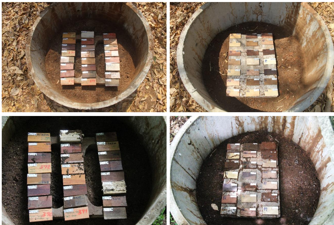
ภาพที่ ๒ การทดสอบผลิตภัณฑ์วัสดุทดแทนไม้ในภาคสนาม
