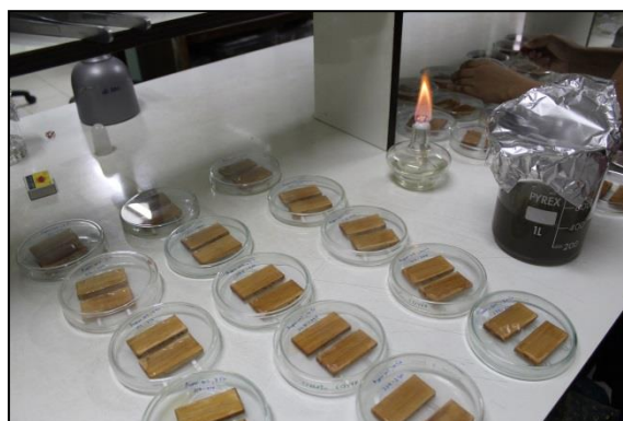
ภาพที่ ๑ ขั้นตอนทดสอบสารแทนนินจากสีเสียดเปลือกในการป้องกันเชื้อราเสียดและราผิวไม้
