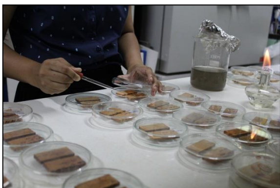
ภาพที่ ๑ ขั้นตอนทดสอบสารแทนนินจากสีเสียดเปลือกในการป้องกันเชื้อราเสียดและราผิวไม้
