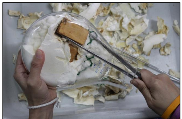
ภาพที่ ๒ ขั้นตอนการทดสอบสารแทนนินจากสีเสียดแก่นในการป้องกันเชื้อราทำลายไม้
