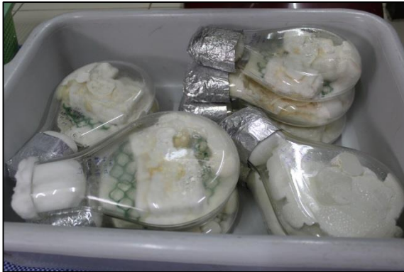
ภาพที่ ๒ ขั้นตอนการทดสอบสารแทนนินจากสีเสียดแก่นในการป้องกันเชื้อราทำลายไม้
