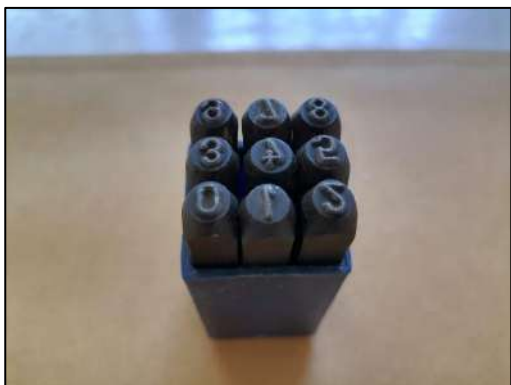
๒๑. ตัวตอกหมายเลข - ทำหมายเลขบนป้ายโลหะ
