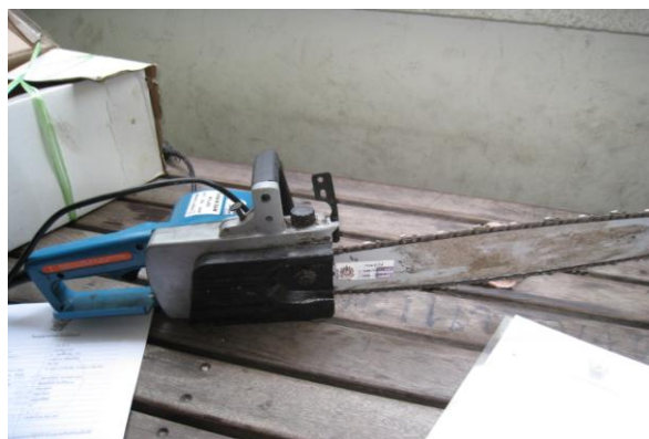
เลื่อยโซยนต์เครื่องจักรกลต้นกำลัง “มอเตอร์ไฟฟ้า”
